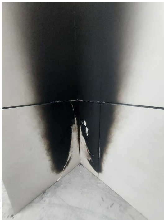
Aspecto de la antes y después del ensayo de SBI (ala corta y ala larga)
